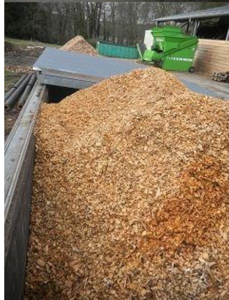
(4) ふるいにかけて細かいチップは発熱用に転用する。これらは全て林地残材である。チップの含水率を 10%くらいまでに下げなくてはいけないので、発電施設で乾燥も行っている。ふるいにかけてられたチップは、施設内で乾燥し、ベルトコンベアで自動的に、燃焼のペースにあわせて燃焼室に送られる。1時間に 0.9 m<sup>3</sup> くらいの材が必要である。年間、約 7,500 時間稼働する。
