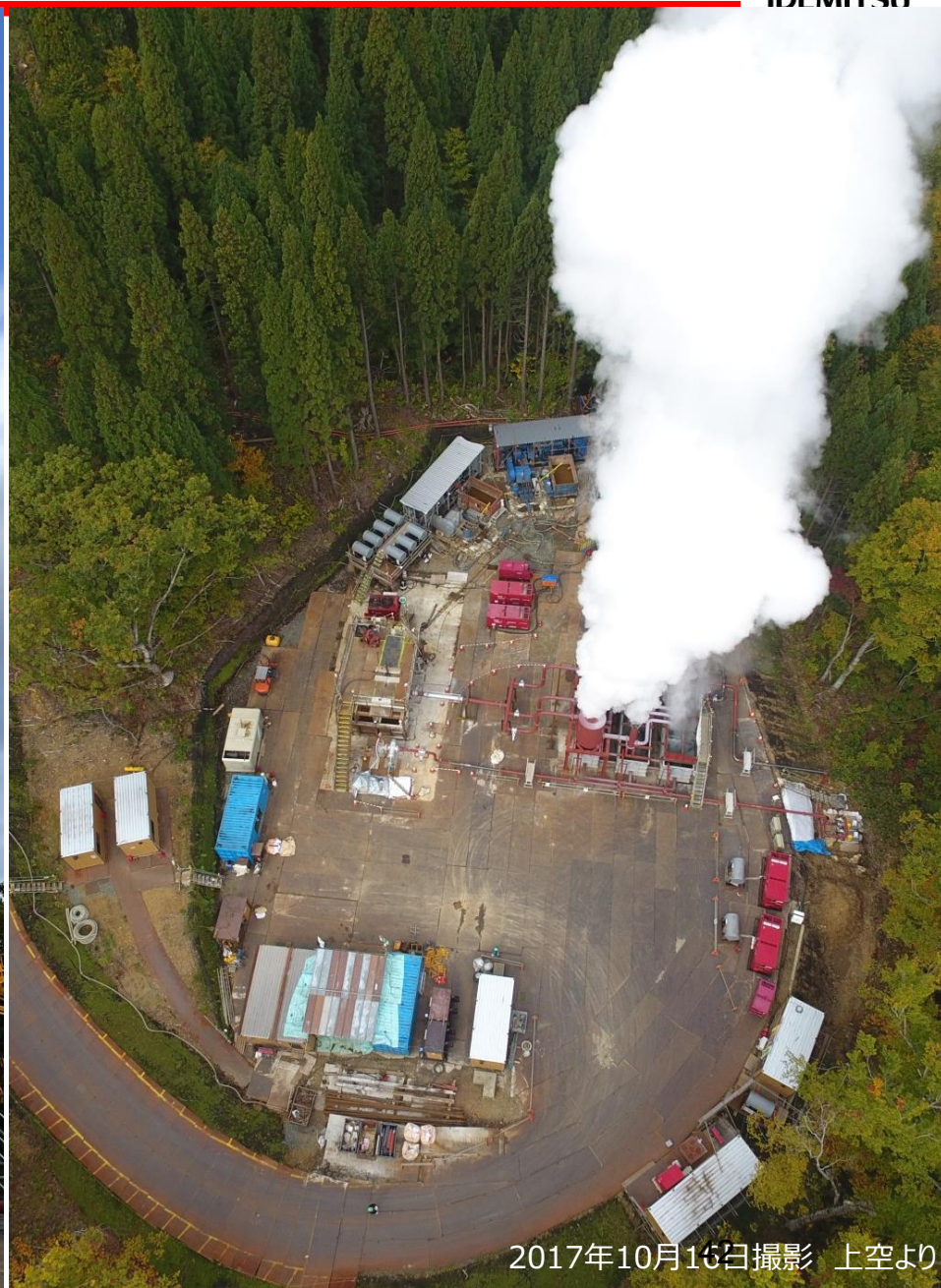
2017年10月11日撮影 大気開放で約50t/hの蒸気量
