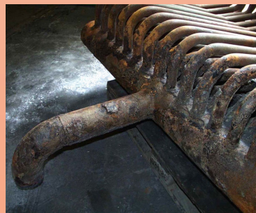
Clによる空気予熱器や煙道ガス冷却管の腐蝕
