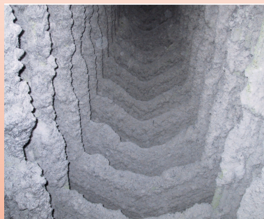
高温燃焼時の灰分, KClによるクリンカの集積
